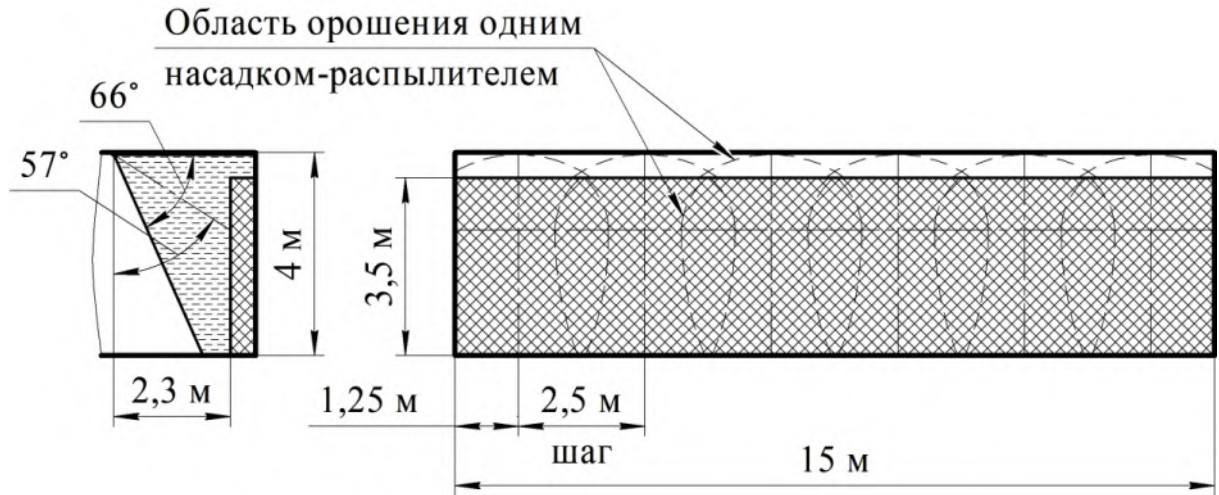
Рисунок 9. Противопожарная защита стеллажа 6-ю насадками-распылителями
