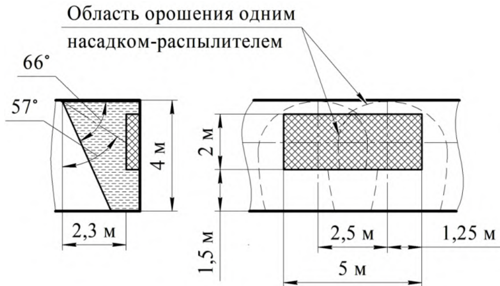
Рисунок 10. Противопожарная защита навесного шкафа 2-мя насадками-распылителями
